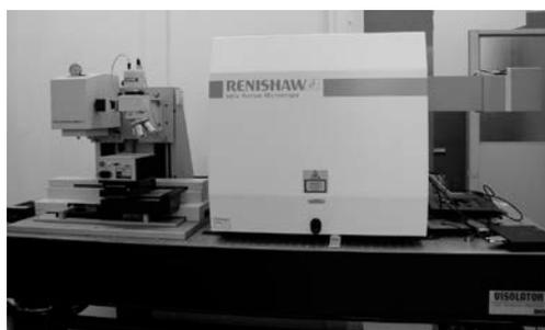
図3 顕微ラマン分光・押し込みシステム
